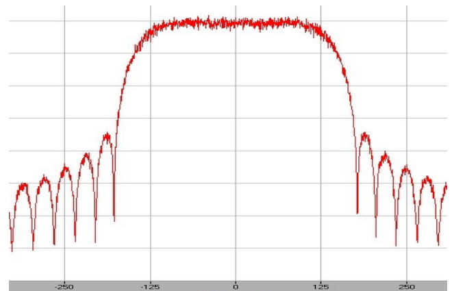
Spectre du même signal avec filtre de Nyquist
